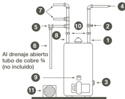
**IMPORTANTE:** siempre debe utilizar tubería metálica a la entrada de agua fría y a la salida de agua caliente. Si tiene otro tipo de tubería (plástico), debe instalar mínimo 60 cm con tubería metálica o bien lo indicado por el fabricante de la tubería plástica utilizada. Su calentador funciona correctamente con cualquier tubería de cobre o ducto metálico especializado para conducción de GAS y AGUA, siempre y cuando estos dispositivos se instalen correctamente.
